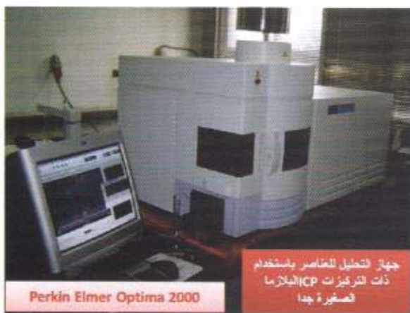
يقوم هذا الجهاز بتحليل جميع انواع العينات لمعرفة التركيب الجزيئي لها.
