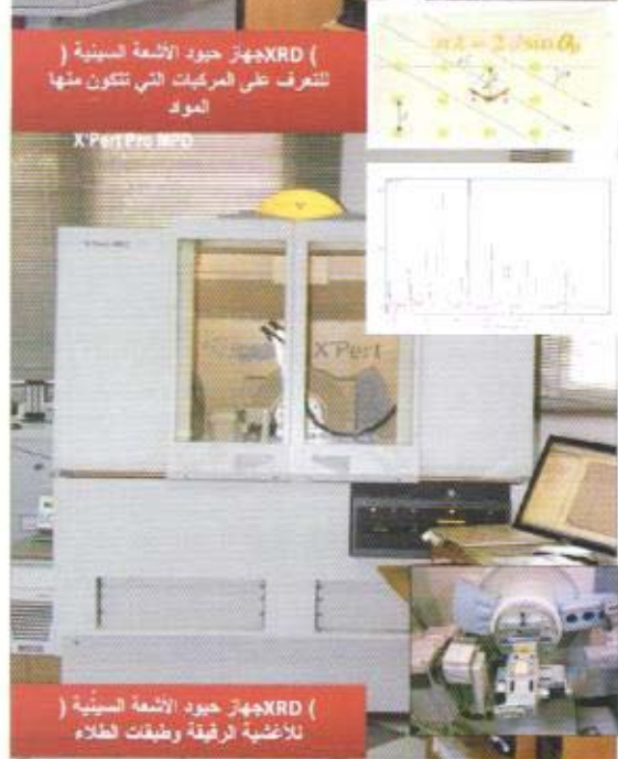
يقوم هذا الجهاز بتحليل جميع انواع العينات لمعرفة التركيب الجزيئي لها.
