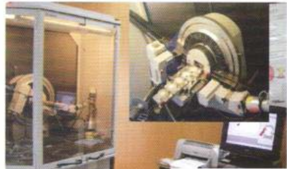
( XRD )جهاز حيود الاشعة السينية للتعرف على المركبات التي تتكون منها المواد
